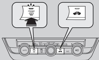
Al pulsar el botón
