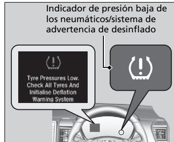
Esto provocará que se encienda el indicador de presión baja de los neumáticos/sistema de advertencia de desinflado y que aparezca un mensaje en la interfaz de información del conductor.
