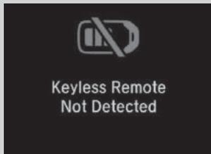
Cuando el modo de alimentación está en cualquier modo que no sea APAGADO y retira el control a distancia sin llave del vehículo y cierra la puerta, suena una alarma. Si sigue sonando la alarma, coloque el control a distancia sin llave en otro sitio.
