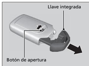
Se puede utilizar la llave integrada para bloquear/desbloquear las puertas cuando la pila del control a distancia de acceso sin llave se está agotando y la función de bloqueo/desbloqueo eléctrica de las puertas está deshabilitada.
