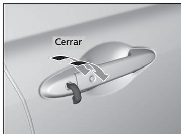
Bloquee la puerta del conductor con la llave. Antes de que transcurran 10 segundos desde que la llave se colocó de nuevo en la posición central, gire la llave en el sentido de bloqueo y manténgala en esa posición.
