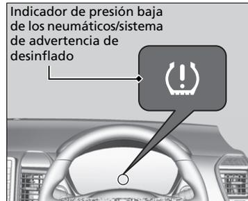
Si se produce esa situación, se encenderá el indicador de presión baja de los neumáticos/sistema de advertencia de desinflado.
