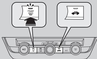
1. Ajuste el ventilador a una velocidad alta.
