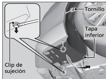
1. Retire el tornillo con un desarmador de cruz y desmonte los clips de sujeción con un desarmador de punta plana.
