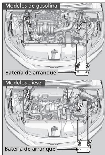
2. Conecte el primer cable de arranque al borne ⊕ de la batería de su vehículo.
