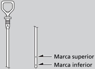
4. Retire de nuevo la varilla de medición del nivel y compruebe el nivel. Debería encontrarse entre las marcas superior e inferior. Añada aceite según sea necesario.
