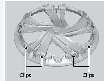
Alinee la marca de la válvula del tapacubos con la válvula del neumático en la rueda y monte el tapacubos.
