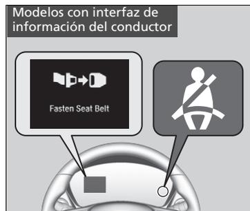
El sistema del cinturón de seguridad incluye un indicador en el tablero de instrumentos para recordar al conductor, al acompañante o a ambos que deben abrocharse los cinturones. Si el modo de alimentación está en CONTACTO antes de que el conductor se haya ajustado el cinturón, el indicador parpadeará. Si el conductor no se abrocha el cinturón, el indicador permanecerá encendido.
