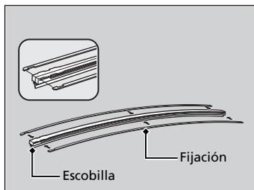
**3.** Saque la escobilla del limpiaparabrisas del soporte jalando del extremo con lengüeta hacia fuera.
