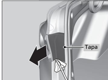
2. Haga palanca en el borde de la tapa con un desarmador de punta plana para desmontarla.
