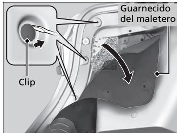
1. Retire los clips de sujeción con un desarmador de punta plana y retire el forro.
