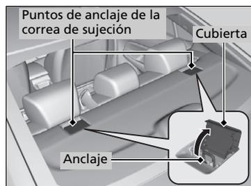
Hay un punto de anclaje para la correa de sujeción detrás de cada asiento trasero exterior. Si dispone de un sistema de sujeción infantil que incluye una correa de sujeción pero que se puede instalar con cinturón de seguridad, se puede utilizar la correa para mayor seguridad.
