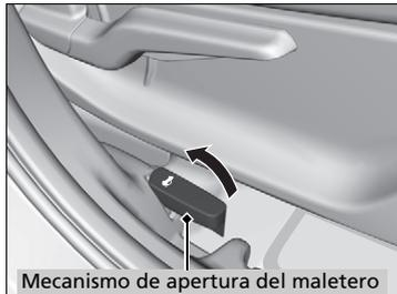
Al tirar del mecanismo de apertura del maletero en la parte exterior del asiento del conductor se desbloquea y abre el maletero.
