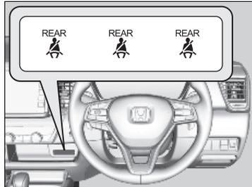
El vehículo supervisa el uso de los cinturones de seguridad de los asientos traseros. El indicador de recordatorio de los cinturones de seguridad de los asientos traseros le informa de si no se está utilizando alguno de los cinturones de seguridad de los asientos traseros.
