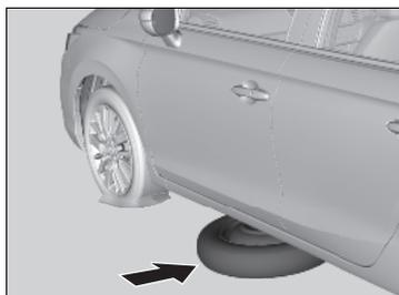
5. Coloque el neumático de repuesto (con la llanta hacia arriba) debajo del vehículo, cerca del neumático que va a sustituir.
