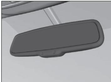
Al conducir de noche, el retrovisor automático antirreflejo reduce el reflejo de los faros del vehículo que circula detrás en función de las señales recibidas desde el sensor del retrovisor. Esta función siempre está activa.
