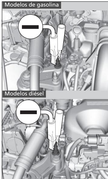
5. Conecte el otro extremo del segundo cable de arranque al perno de montaje del motor como se muestra. No conecte este cable de arranque a ninguna otra parte.
