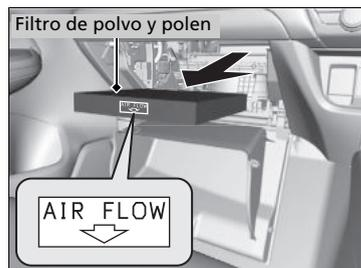
4. Presione las lengüetas de las esquinas de la tapa de la carcasa del filtro y retire la tapa.
