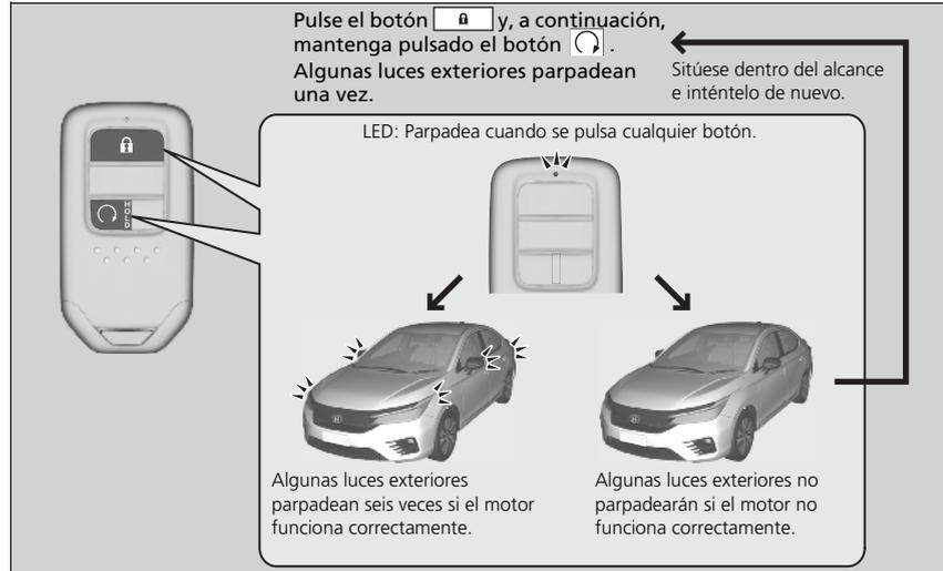
Cuando se arranca de forma remota, el motor se apaga automáticamente tras 10 minutos en ralentí o si no se ha pisado el pedal de freno a la vez que se ha pulsado el botón **ENGINE START/STOP**.
