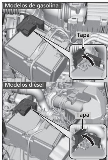
1. Abra la tapa del terminal por el borne positivo de la batería ⊕ de su vehículo.
