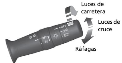
Modelos con control automático de luces
