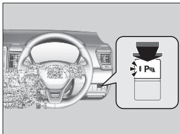
Con la modalidad de alimentación en CONTACTO, oprima el botón del sistema de sensores de estacionamiento para activarlo o desactivarlo. El indicador en el botón se enciende cuando el sistema está activado.
