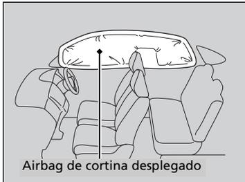
El airbag de cortina está diseñado para desplegarse en un impacto lateral de moderado a fuerte.
