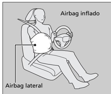
Cuando los sensores detectan un impacto lateral de moderado a fuerte, la unidad de control envía una señal al airbag lateral del lado que ha sufrido el impacto para que se infle de inmediato.
