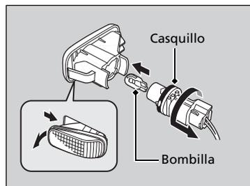
1. Empuje la parte delantera del conjunto de intermitente lateral hacia la parte trasera del vehículo hasta que salga de la carrocería.
