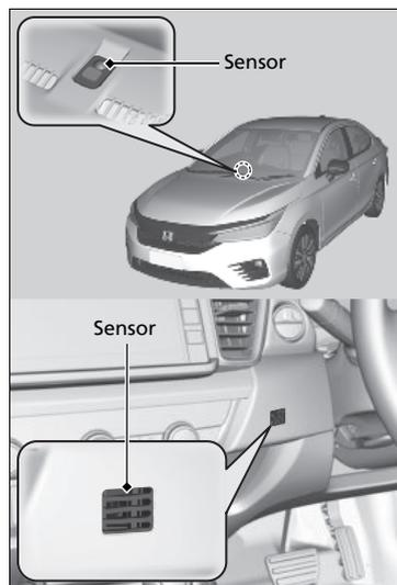
El sistema de aire acondicionado automático está equipado con sensores. No los tape ni vierta líquidos sobre ellos.
