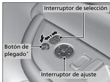
Solamente puede ajustar los retrovisores exteriores cuando el modo de alimentación está en CONTACTO.
