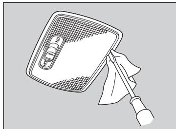
1. Haga palanca en el borde de la tapa con un destornillador de punta plana para desmontarla.
