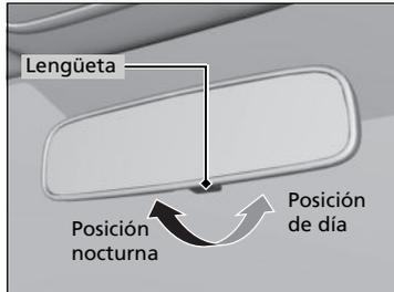
Dé la vuelta a la lengüeta para cambiar la posición. La posición nocturna contribuye a reducir el deslumbramiento de los faros de los vehículos posteriores después del crepúsculo.
