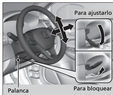
1. Empuje la palanca de ajuste del volante hacia abajo.
