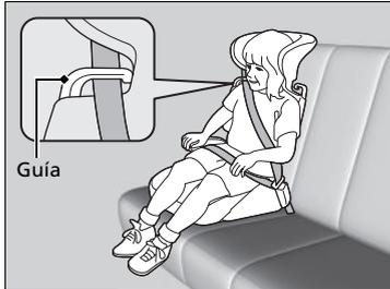
Hay disponible un respaldo para un asiento elevador determinado. Instale el respaldo en el asiento elevador y ajústelo al asiento del vehículo siguiendo las instrucciones del fabricante del elevador. Asegúrese de que el cinturón de seguridad se pasa correctamente a través de la guía del hombro del respaldo y que el cinturón no toca ni cruza el cuello del niño.
