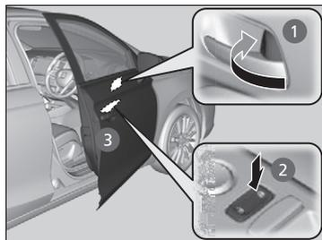
■ **Bloqueo de la puerta del conductor** Empuje la lengüeta de bloqueo hacia delante **1** o empuje el interruptor de bloqueo centralizado de puertas en la dirección de bloqueo **2** y después mantenga estirada la manija exterior de la puerta **3**. Cierre la puerta y suelte la manija.
