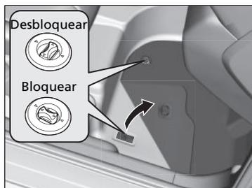
La alfombra del piso del conductor queda enganchada por encima de los anclajes del piso, lo que impide que se deslice hacia delante. Para desmontar una alfombra para limpiarla, gire los controles del anclaje a la posición de desbloqueo.. Cuando vuelva a montar la alfombra después de limpiarla, gire los controles a la posición de bloqueo.
