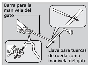
3. Eleve el vehículo con la manivela del gato y la barra de prolongación hasta que el neumático se levante del suelo.
